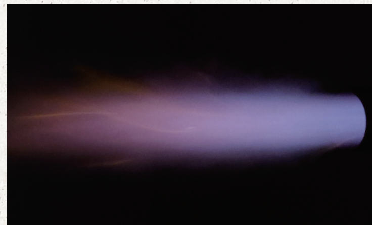
水素バーナ 安全に燃焼させること、排ガスの NOx 量を低減させることが課題の水素バーナ。実用化に向けて研究を重ねています。
